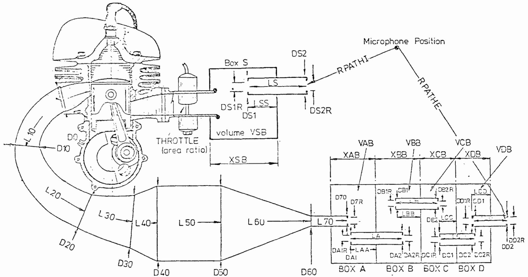
EXHAUST AND INTAKE SILENCING BOX PARAMETERS REQUIRED FOR PROGRAM GPB 2.
