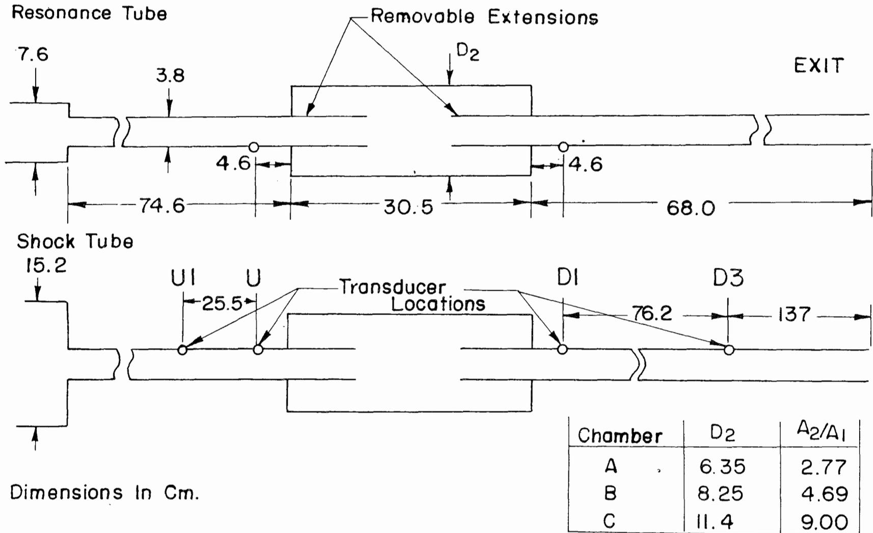
FIGURE 9 EXPANSION CHAMBER SYSTEMS
