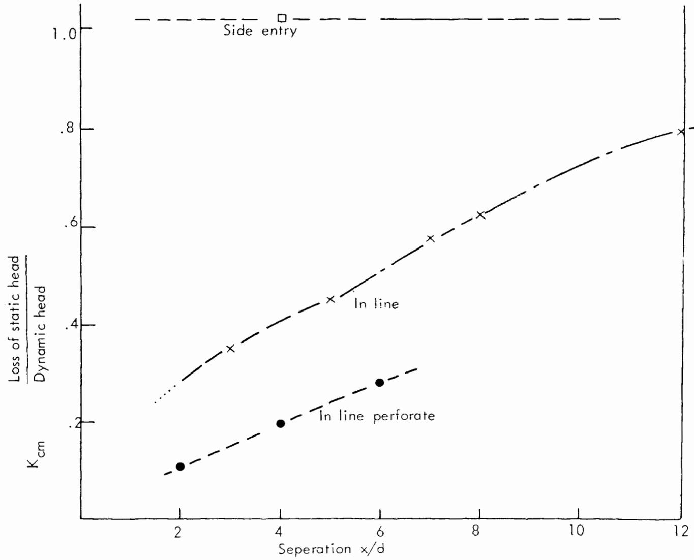
FIG. 8. BACK PRESSURE OF EXPANSION CHAMBERS.
