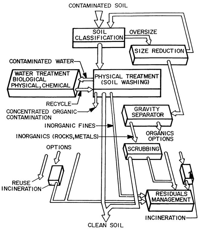
PROCESS DIAGRAM FOR SOIL WASHING SYSTEM
