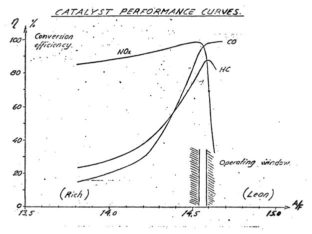
CLOSED LOOP (LAMBOA-SOND) FUEL INJECTION SYSTEM.
