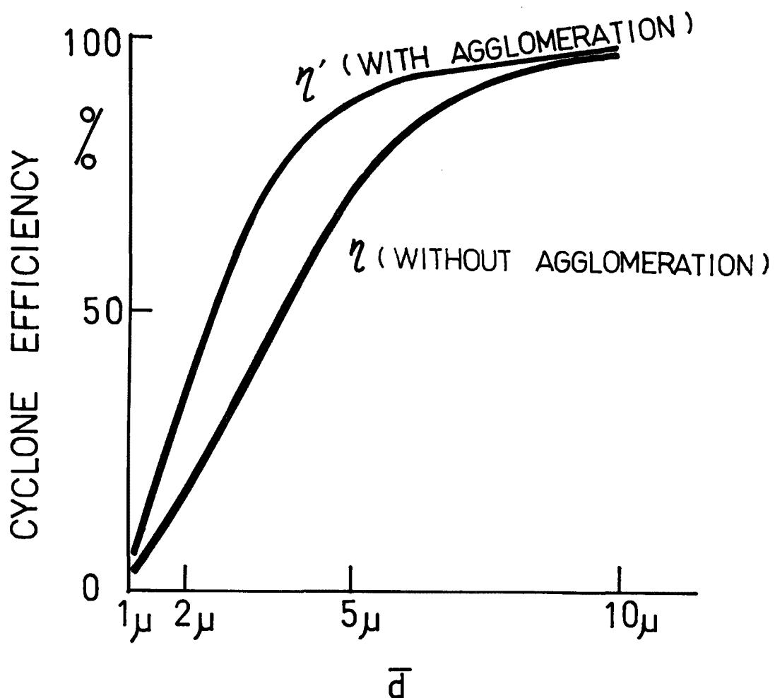
FIGURE 3. COMPUTED EFFICIENCY VS.
