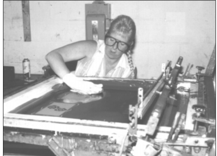
Limpieza de tamices con una lavadora de prensa de evaporación lenta
