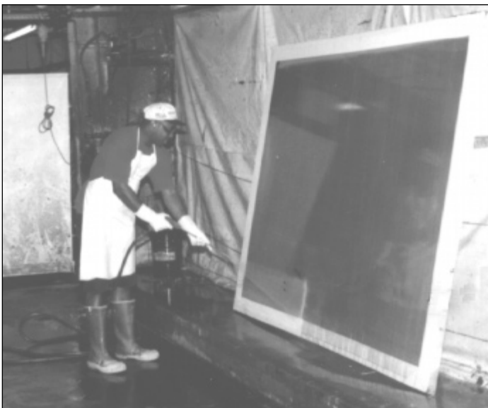
Recuperación de tamices con un sistema de agua de alta presión
