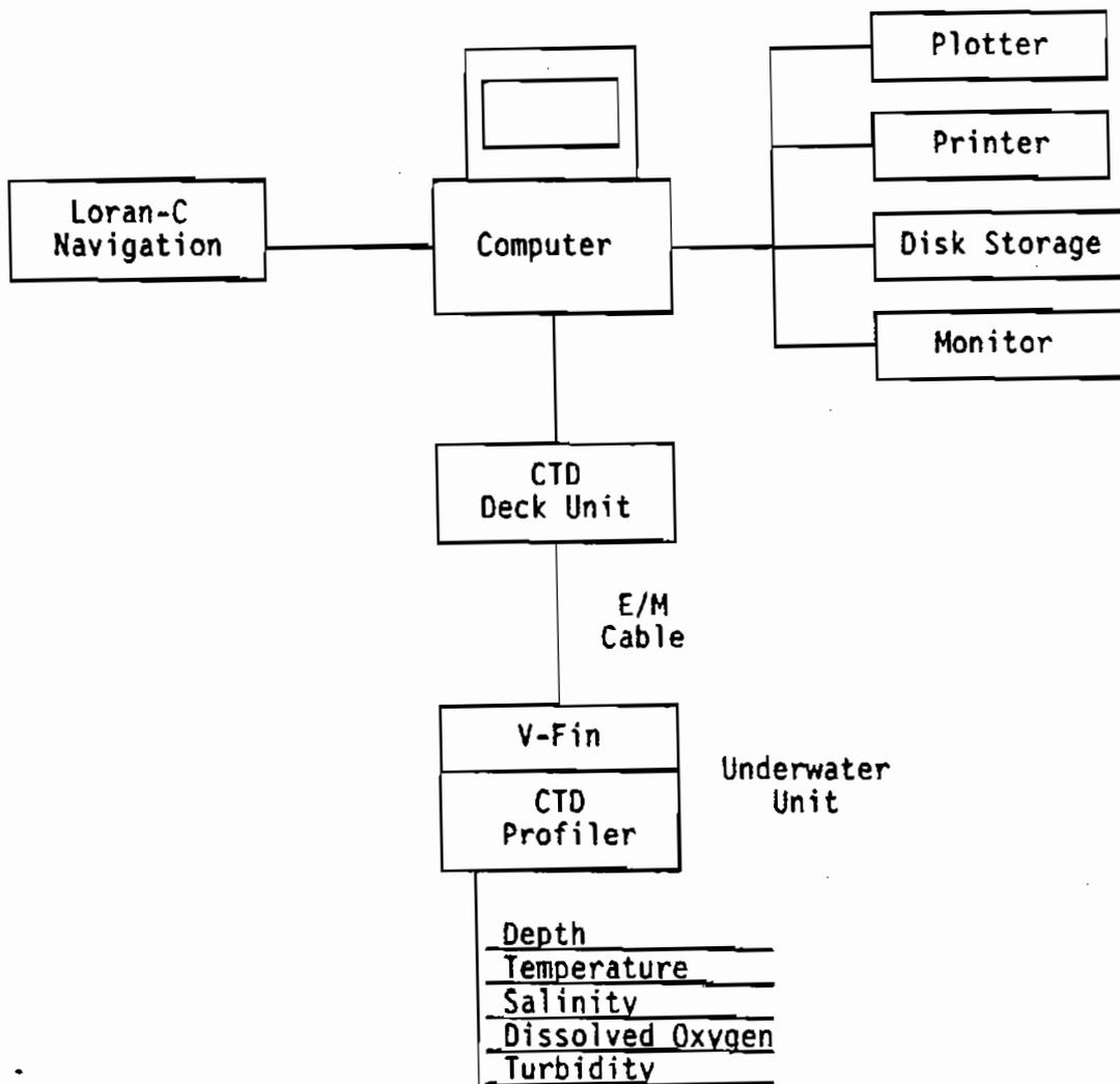
FIGURE 3-1. SCHEMATIC DIAGRAM OF SHIPBOARD DATA ACQUISITION SYSTEM
