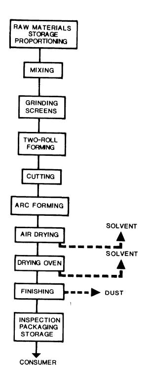
FIGURE 3- WET-MIXED MOLDED BRAKE LINING MANUFACTURING OPERATIONS
