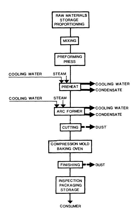
FIGURE 2- DRY-MIXED BRAKE LINING MANUFACTURING OPERATIONS
