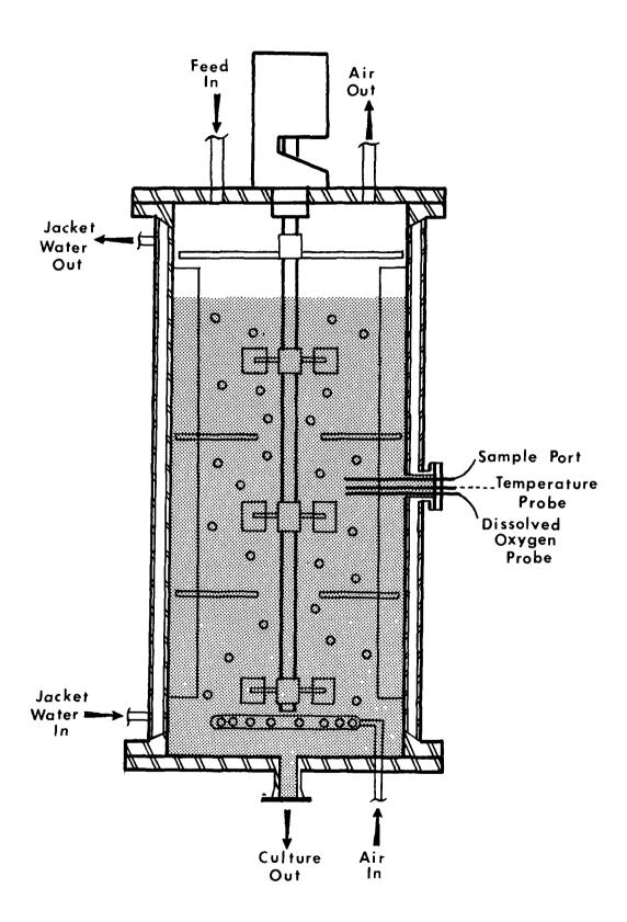
Figure 19. Pilot-plant fermenter.
