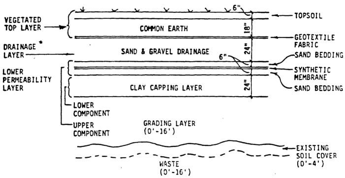
\* THE DRAINAGE LAYER WAS SPECIFIED AT 24 IN. TO MEET THE REQUIREMENT THAT THE UPPER COMPONENT OF THE LOW PERMEABILITY LAYER BE LOCATED AT LEAST 12 IN. BELOW THE MAXIMUM RECORDED DEPTH OF FROST WHICH WAS ESTIMATED TO BE 36 IN.
