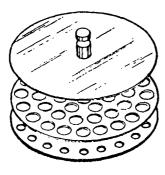
AMPULE RACK FOR PRESSURE VESSEL (43 AMPULE CAPACITY)
