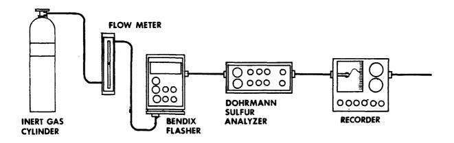
FIGURE 2. PURAMER S BASED SULFUR DIOXIDE MONITORING SYSTEM - ANALYZER SYSTEM.
