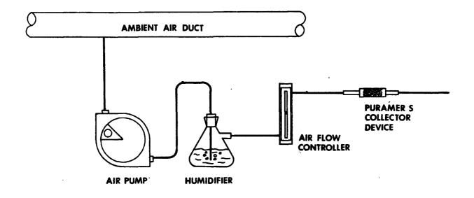
FIGURE 1. PURAMER S BASED SULFUR DIOXIDE MONITORING SYSTEM-COLLECTOR SYSTEM.
