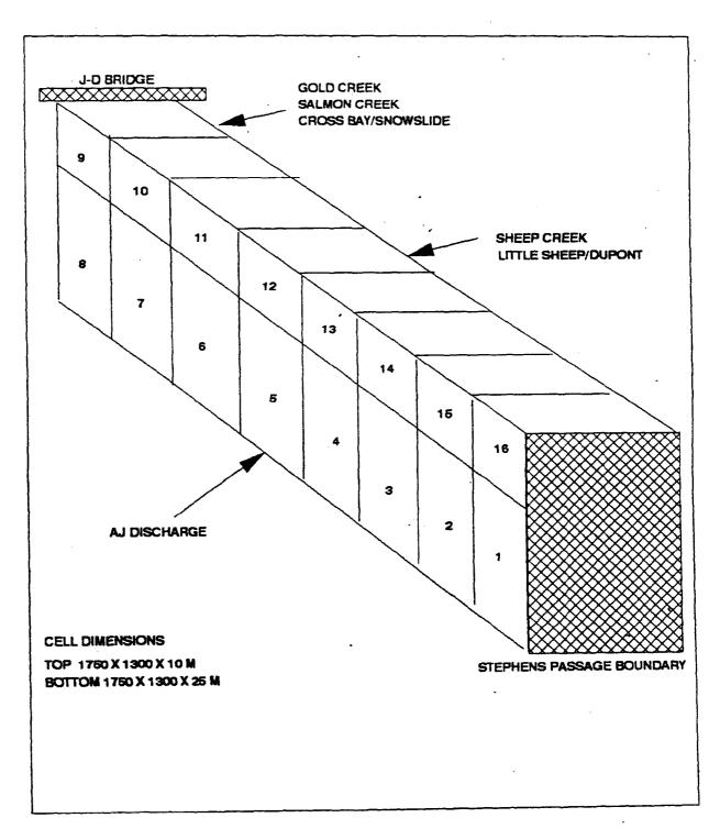
Figure 30: WASP4 GRID AND BOUNDARIES FOR GASTINEAU CHANNEL MODEL
