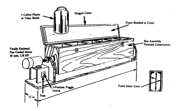
FIGURE 4. COMPACTION TESTER
