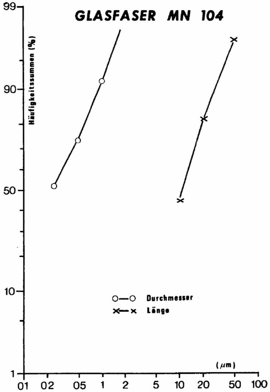
Abbildung 1: Häufigkeitsverteilung von Länge und Durchmesser der Glasfaser MN 104
