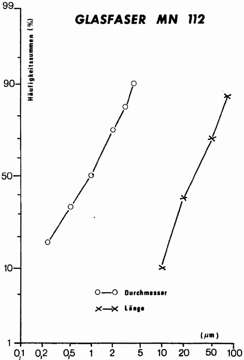
Abbildung 2: Häufigkeitsverteilung von Länge und Durchmesser der Glasfaser MN 112
