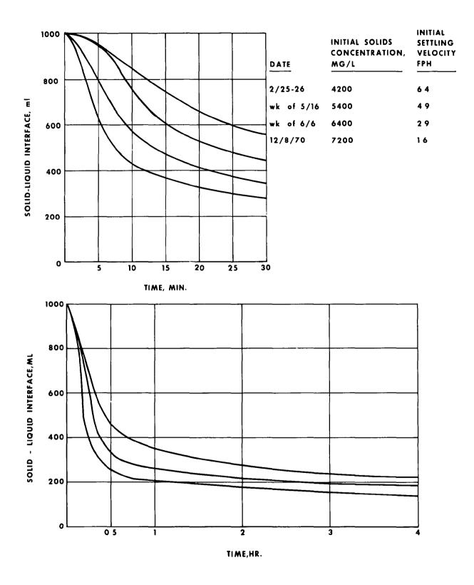
FIG. 4 TYPICAL SOLIDS SETTLEABILITY CURVES
