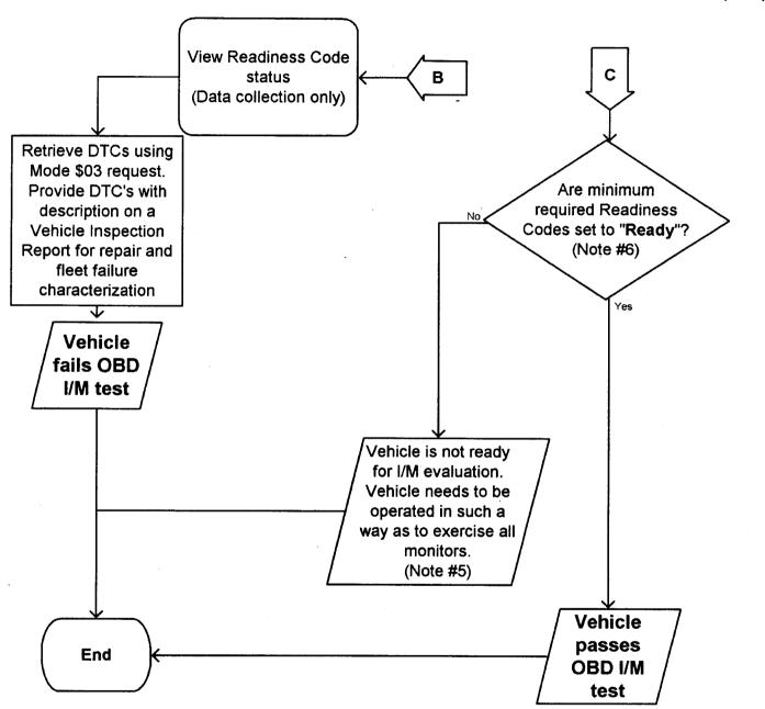
OBD I/M RECOMMENDED TEST PROCEDURE FOR 1996 MODEL YEAR AND NEWER VEHICLES (Cont.)
