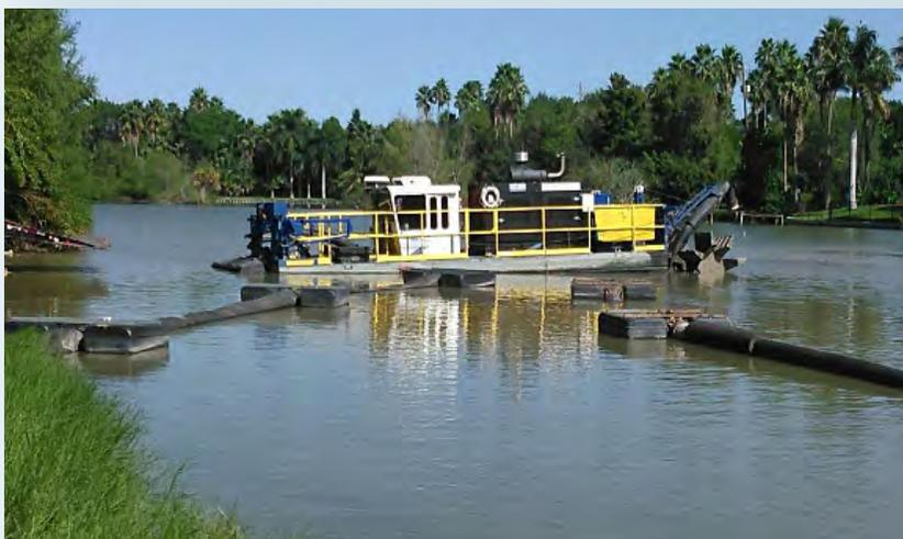
La draga flotante de IMS Dredges® es autopropulsada y tiene una cabeza de corte de 2.75 metros (9 pies). El sedimento se transporta a través de tuberías flotantes a un sistema de deshidratación fuera del sitio. **Cortesía de:** Junta de Servicios Públicos de Brownsville.
