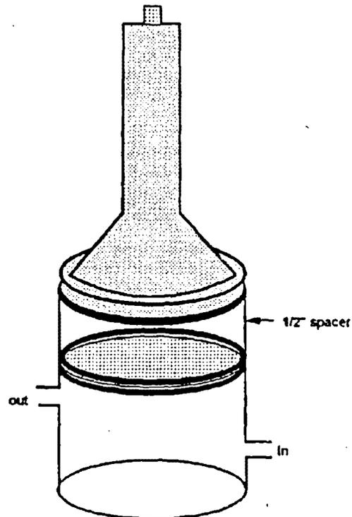
Fig. 2 Radon Diffusion Test Cell
