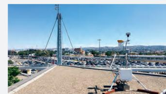
Equipo de monitoreo instalado en una azotea para medir los niveles de PM<sub>2.5</sub> mientras el tráfico avanza en el puerto fronterizo de San Ysidro.
